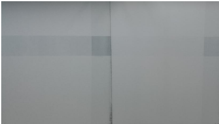
Rysunek: 1. Siła krycia tego samego produktu przy zastosowaniu dwóch różnych wałków do malowania. Po lewej najbardziej popularny wałek do malowania gładkich powierzchni typu microfibra, a po prawej wałek Polyamid Power.
